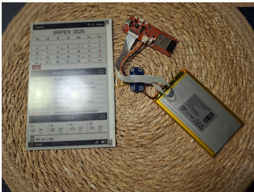
Ukázka propojených komponent před vložením do krytu. Ploché kabely displeje ostře neohýbejte.
